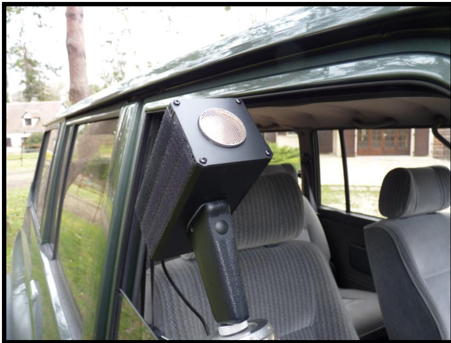
Photo 3 : Micro ultrason fixé sur le véhicule.
