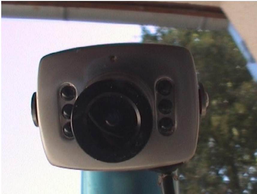
La caméra avec ses diodes infrarouges
